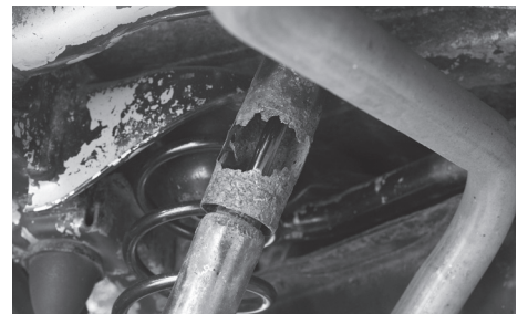
ショックアブソーバーのチューブも大きな穴が空いています。雪道を走った後、そのままにしておくとすぐにサビてきますよ!
