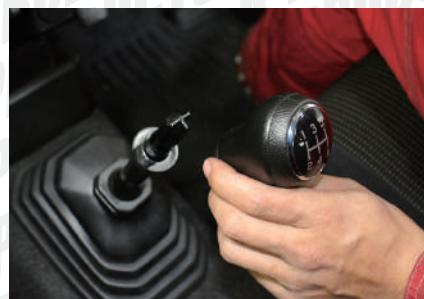
2. シフトノブを抜くとプラケットがシフトレバーに取り付いていますので、プライヤー等の工具を使い、左に回し取り外します。
