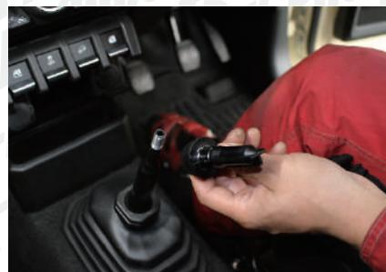
3. シフトバーのネジ山部分に残っている「ゆるみ止め材」をダイスで奇麗に取り払います。(ピッチ M10×1.25)
