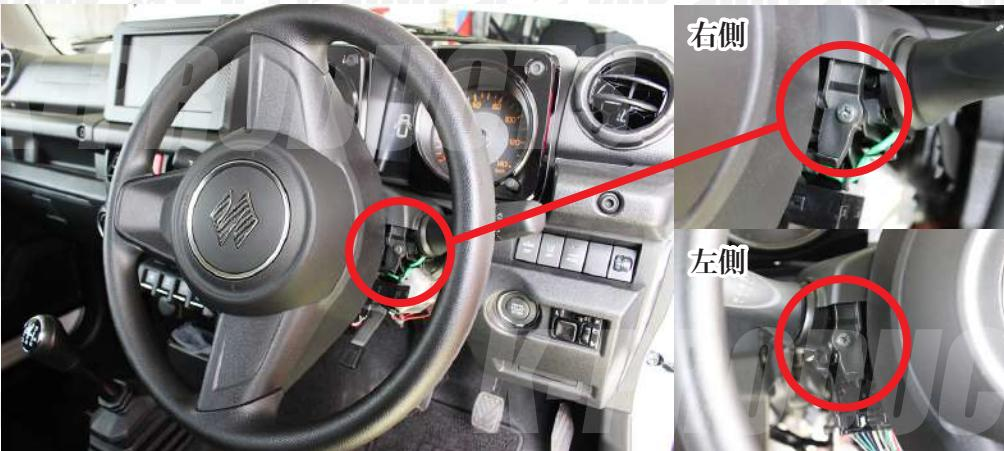
5. 2 本のボルトを外したら、ステアリングをセンターに戻し、コラムカバー上側を外す。
