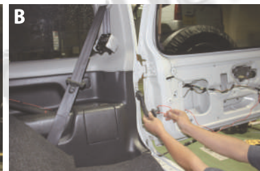
B. 配線をリアゲートから蛇腹パイプに通します。
