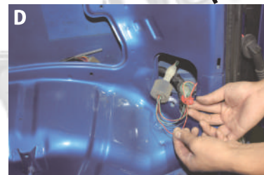
D. スモールランプの配線(赤に黄色のライン)にエレクトリックタップで接続します。最後に配線止めで配線を固定します。
