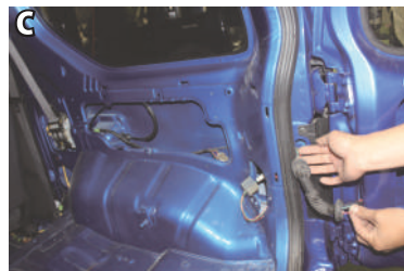
C. リアシートベルトの固定ボルトを外し荷台の内張りを外します。蛇腹パイプに配線を通しボディ側に引き込みます。
