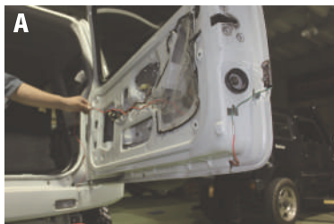
A. ナンバー灯のプラス配線に延長配線を繋ぎリアゲート左下の水抜き穴から配線を入れます。
