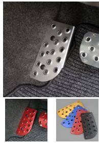
AT車専用品AT車標準装着の物に比べ、上におよそ25mm、右に27mm大きくなり、足の大きな人でも安定し、ロングドライブの足の疲労を和らげてくれます。ステップ面の穴には滑り止めのバーリング加工が施されています。
