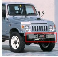
行錯誤した結果のオリジナルバンパーです。クロカン派のあなたにもびったり。ウインカーを装着するためには別途フロントエプロンが必要です。(JA12/22 JB32のフロントグリル内にランプが装着されている車両の場合は不要です。) 3mm厚ステンレス製・パフ仕上 車検適合品
