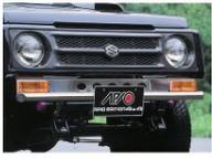
JA11/71に装着する場合、ウインカーを装着するために別途フロントエプロンが必要です。ステンレス製メインパイプ径50mm 車検適合品
