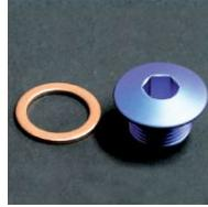
超軽量・高強度・高耐熱性のチタン合金製ボルトです。強度の高さに加えて、特に切削性・溶接性に優れたTi-6AL-4V合金を採用しました。強度はクロームモリブデン鋼（SCM435）と同等で重量はわずか57%！調理器具から最先端医療まで、業界を超えて注目されている理想的な素材なのです。近年ではモータースポーツの世界にも広く浸透し、その優れた特製を活かしたスペシャルパーツが、ダカールラリーを始め数々の過酷なレースの現場で活躍をしています。スチール、アルミ、ステンレス等の素材に比べ熱膨張が少なく、ネジ山の歪みなどの形状変化が少なく、ボルト脱着時のトラブルが避けられます。仕上げは陽極酸化処理によるもので、酸化皮膜がブルーに発色したものです。この方法は素材に電流を流して処理を行いますが、表面のみを酸化させるため、ボルト自体の強度を損なうことなくチタン独自の美しい色が表現されています。
