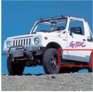
リップを包み込む「多段曲げ加工」により、衝撃に対する強度を高めてあります。
