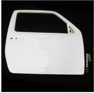
化を実現しています。クロカンやレースでは軽量化が強力な味方となります。また、レース走行前後でのドア脱着時の労力を大幅に低減できます。FRPは弾力のある材質のため、少々ぶつけても復元力があります。さらに、パワーウィンドウと電動ドアミラーを純正品の手動タイプに交換する事で片側2kgの軽量化ができます。
