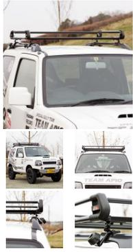
有効深さ：7cm) 精興工業製ルーフラック「タフレック」のアビオ特別バージョン！ジムニーJB23/JB33/JB43の屋根幅に合わせてラック本体の左右を20mmづつ、計40mmショートにし、装着時のイメージをスマートにしました。前後のバーは内側に可倒式になっており、ラック本体より長尺の物もベルトなどで固定することで積載が可能です。アビオ特別仕様では通常別売の保護フィルムが付いてきます。
