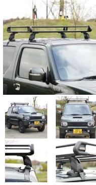
(ラック内 有効長：70cm) 高：10cm (ラック内 有効深さ：7cm) 精興工業製ルーフラック「タフレック」のアビオ特別バージョン！ジムニーJB23/JB33/JB43の屋根幅に合わせてラック本体の左右を20mmづつ、計40mmショートにし、装着時のイメージをスマートにしました。また、通常のルーフレール無し用と脚部カバーのデザインを変更し、脚部もスマートです。
