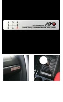
**シフトパターンプレート (5MT) Five-speed Manual Shift (アピオ製)**
